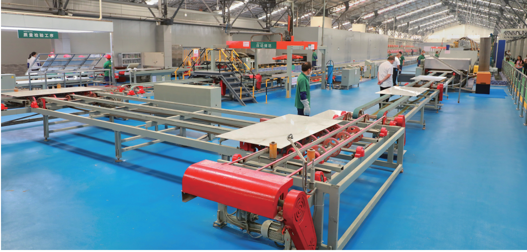
仙湖实验室成功主导研发出的全球首条陶瓷工业氨氢零碳燃烧技术示范量产线。/佛山市新闻传媒中心记者周春摄
