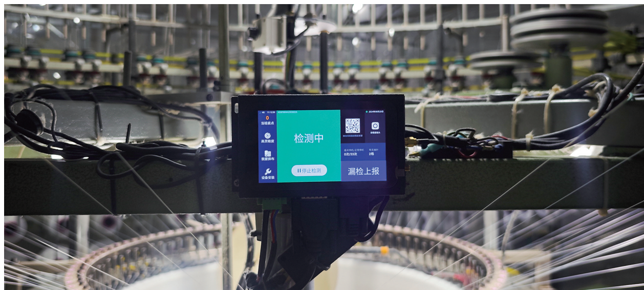
探布无忧-布面缺陷智能检测系统主机。
